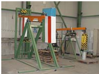
Slika 10. Istraživanja klatna od 1340kg u kompaniji Fondlta, Italija http://www.youtube.com/user/ila67ful
