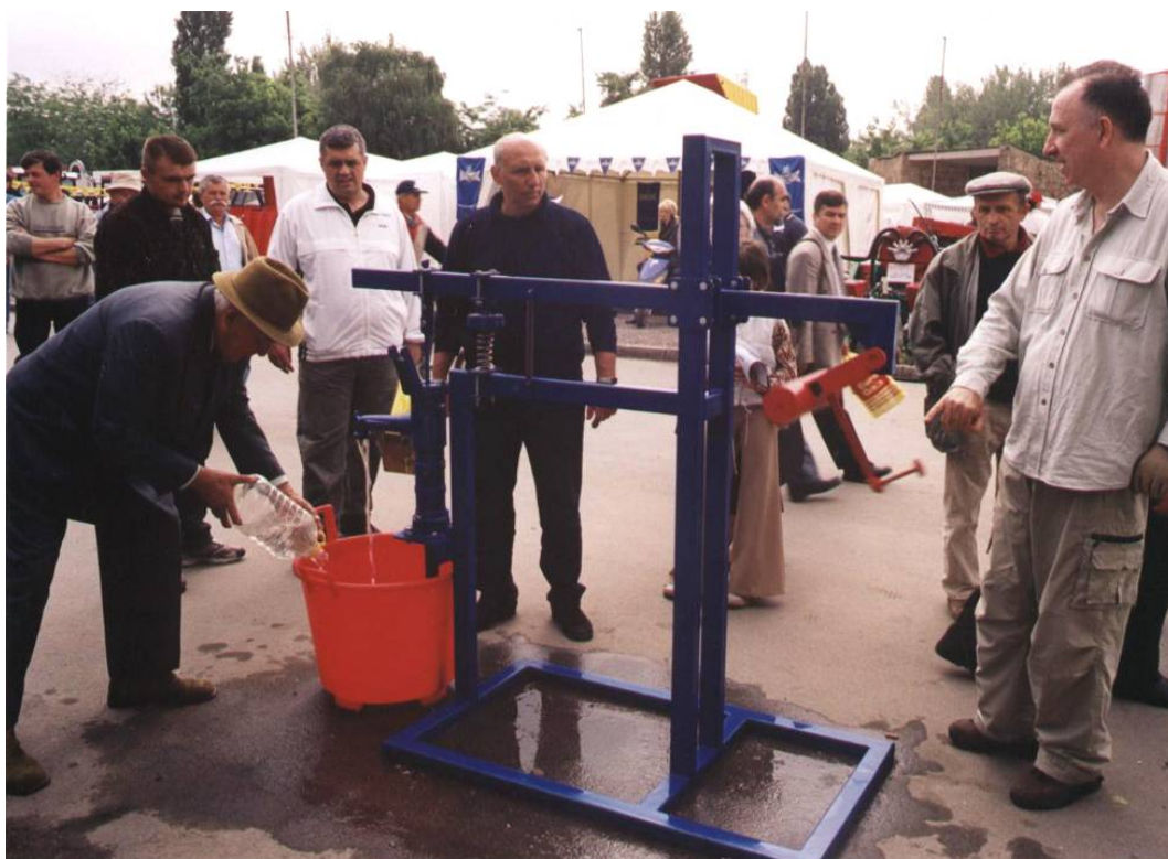
Slika 2. Pumpa sa vodu sa klatnom – praktična primena dvostepenog mehaničkog oscilatora akademika Veljka Milkovića
